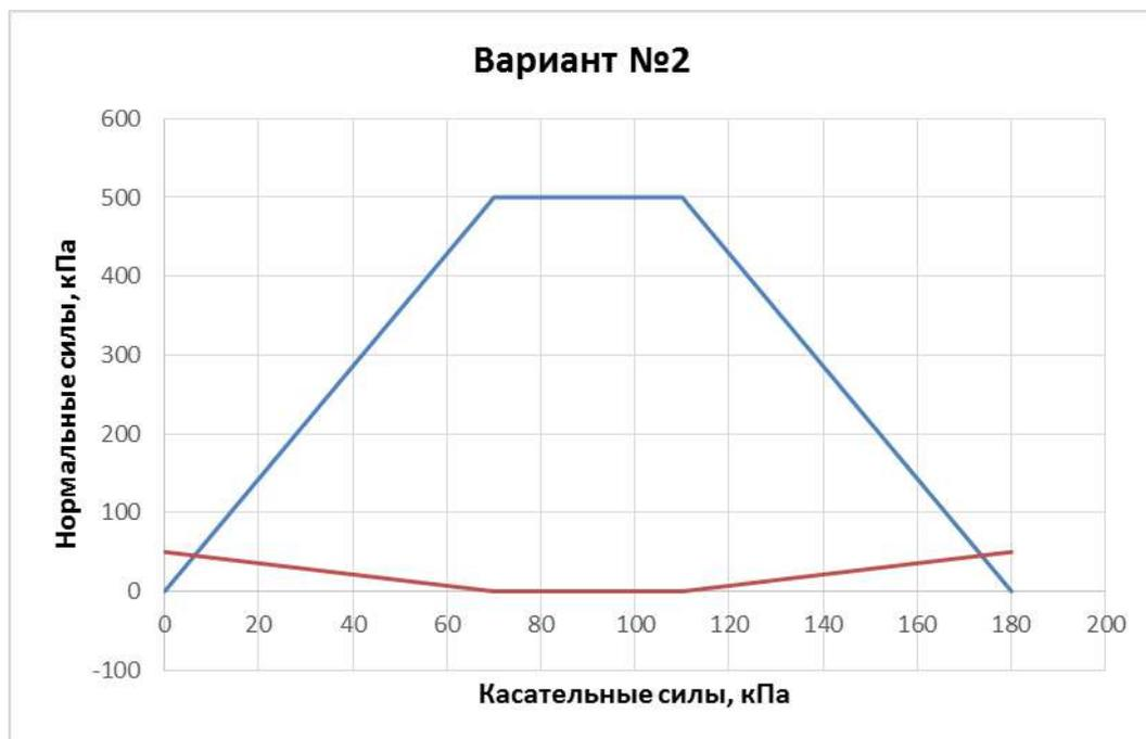
Рис. 4. График зависимости нормальных сил криогенного пучения от касательных при  $\sigma_{\max}=500$  кПа,  $\tau_{\max}=50$  кПа
