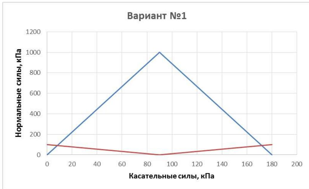
Рис. 3. График зависимости нормальных сил криогенного пучения от касательных при  $\sigma_{\max}=1000$  кПа,  $\tau_{\max}=100$  кПа
