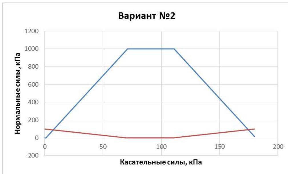
Рис. 5. График зависимости нормальных сил криогенного пучения от касательных при  $\sigma_{\max}=1000$  кПа,  $\tau_{\max}=100$  кПа
