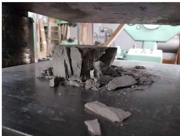
*Рисунок 2. – Определение пределов прочности при сжатии образцов инъекционных растворов*
