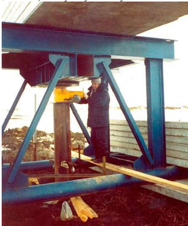
*Рисунок 1. Испытание свай в вечномерзлых грунтах.*
